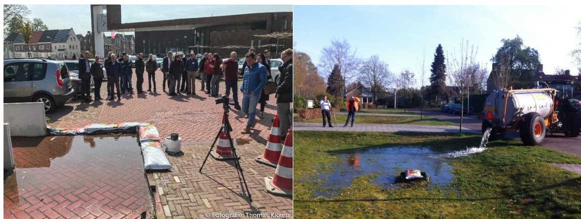
Afbeelding 2. Full scale test aan doorlatende verharding bij gemeentehuis Dalftsen (links) en een wadi (foto's: Thomas Klomp)
